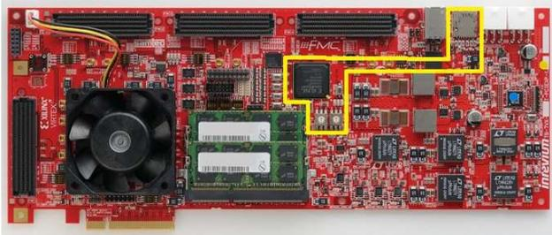
Virtex-7 FPGA搭載 PCI Express Gen3対応評価プラットフォーム
