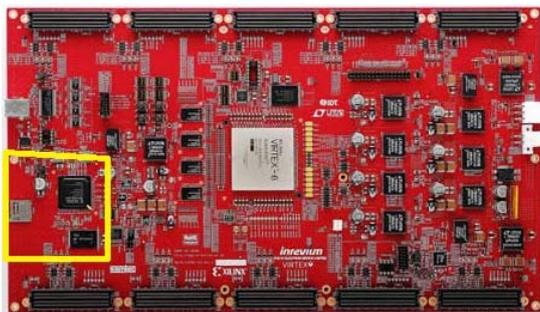
Virtex-6 FPGA搭載LSI開発プラットフォーム
