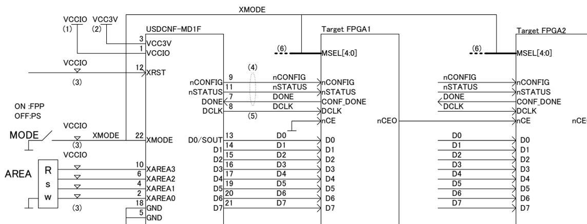
図 5.2.1.1.2 USDCNF-MD1F-001A FPP/PS 選択式 1:2 接続例
