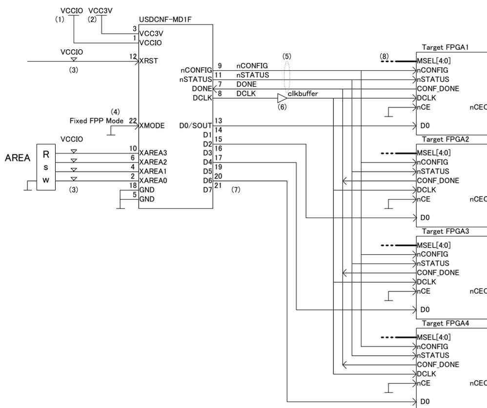
図 5.2.4.2 Multi FPGA x4 接続例
