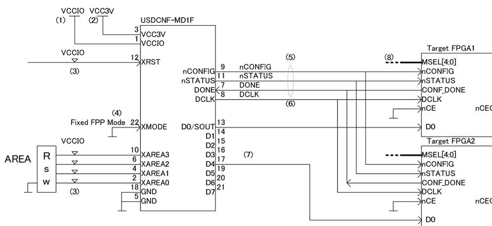
図 5.2.4.3 Multi FPGA x2 接続例
