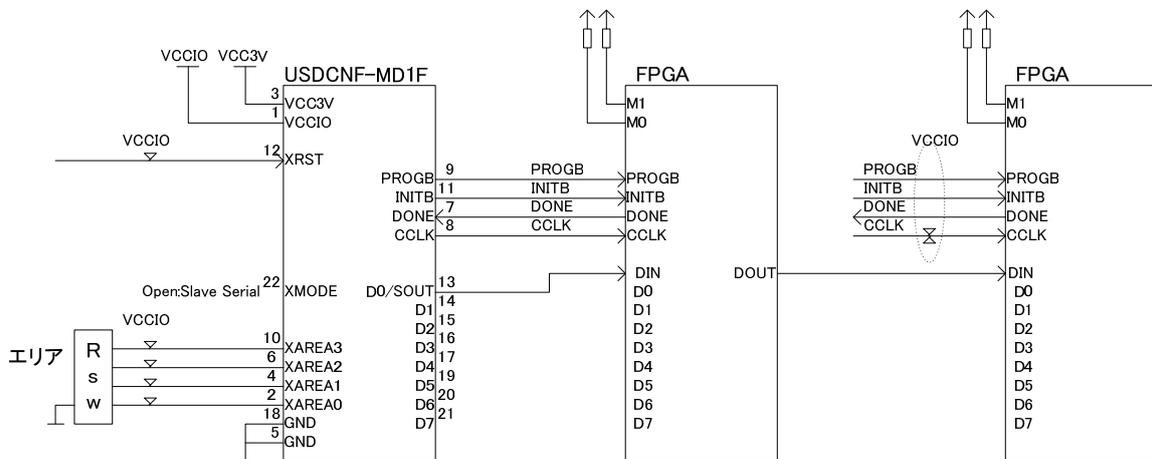
図 5.1.1.2 SlaveSerial モード固定式の接続図
