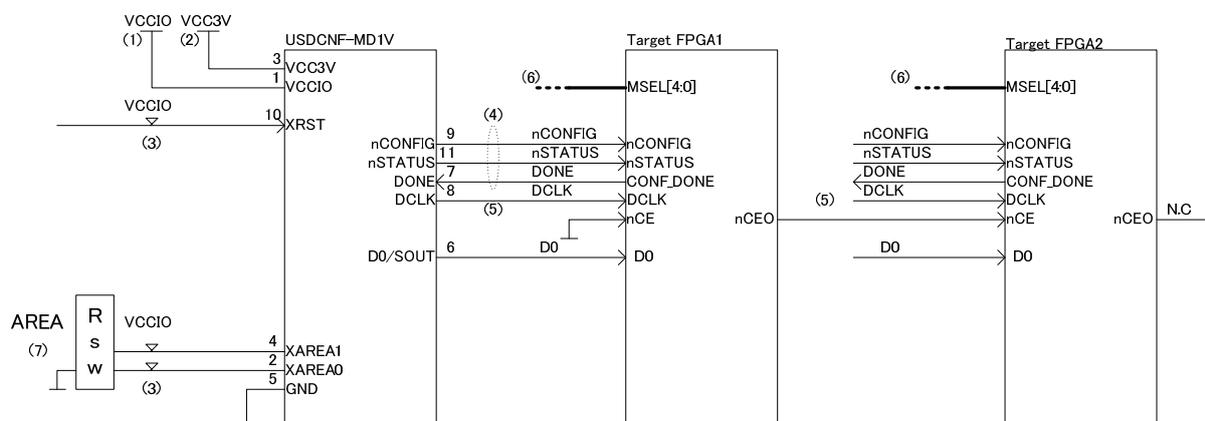
図 5.2.2 USDCNF-MD1V-001A 接続例
