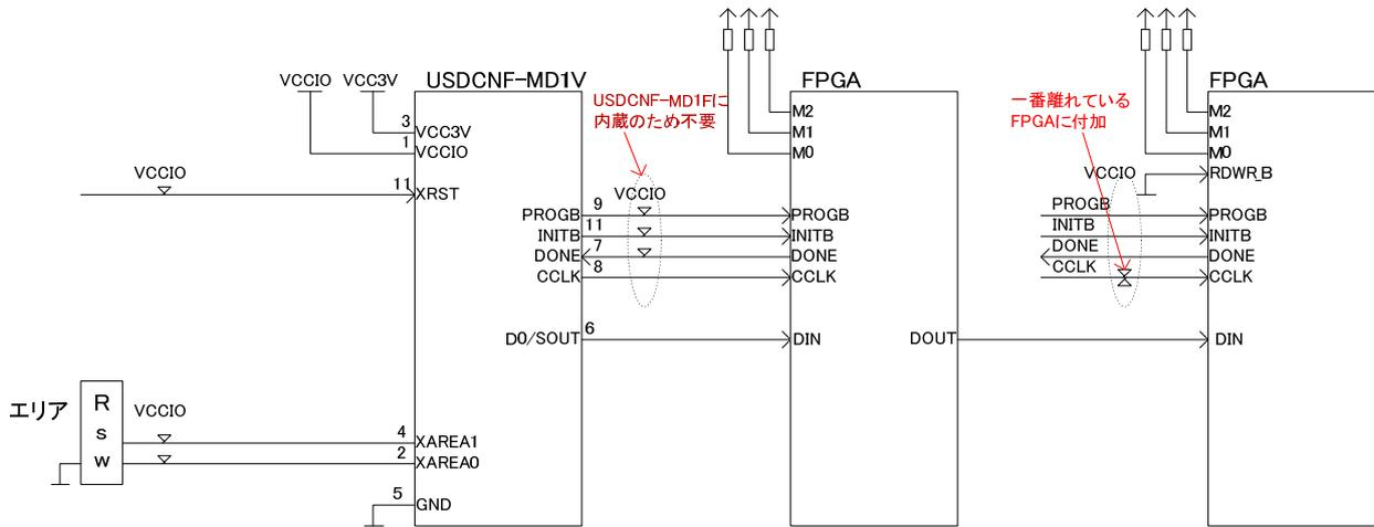
図 5.1.2 USDCNF-MD1V-001A 接続例
