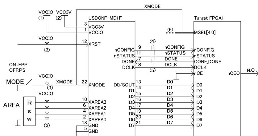
図 5.2.1.1.1 USDCNF-MD1F-001A FPP/PS 選択式 1:1 接続例
