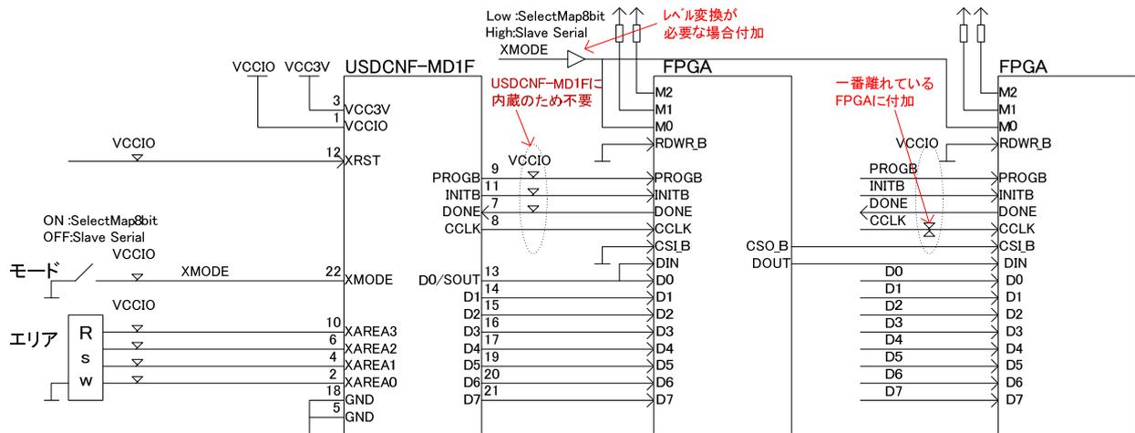
図 5.1.1.1 SlaveSerial/SelectMap8 モード選択式の接続図
