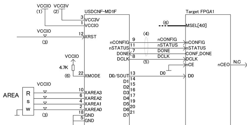
図 5.2.1.2.1 USDCNF-MD1F-001A PS 固定 1:1 接続例
