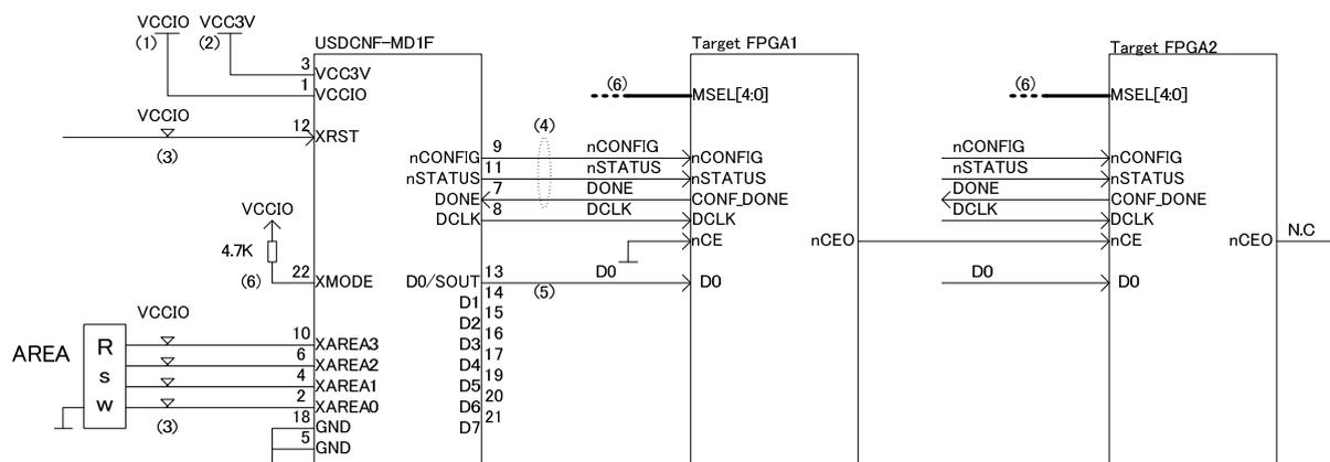
図 5.2.1.2.2 USDCNF-MD1F-001A PS 固定 1:2 接続例
