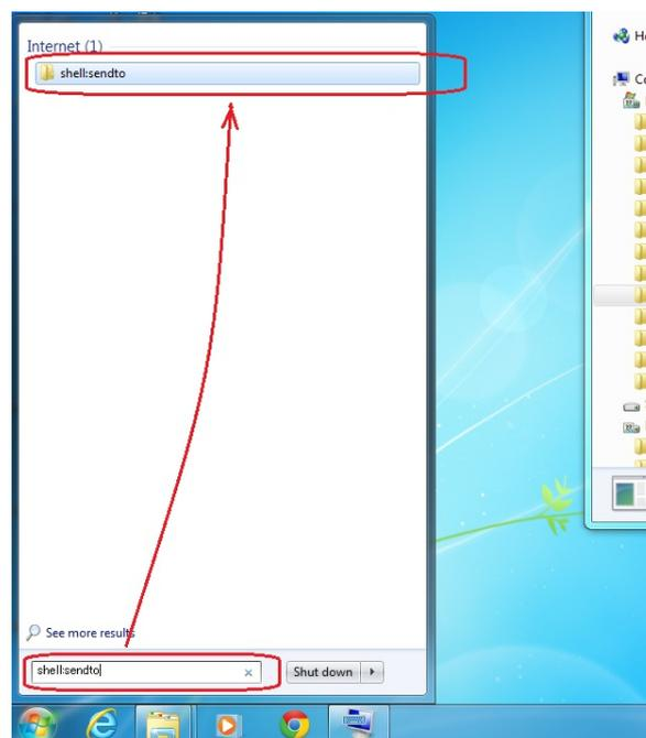
でコピーした reformSVF.exe を右クリックしながらドラッグして shell:sendto のフォルダ上まで移動し、リリースします。
