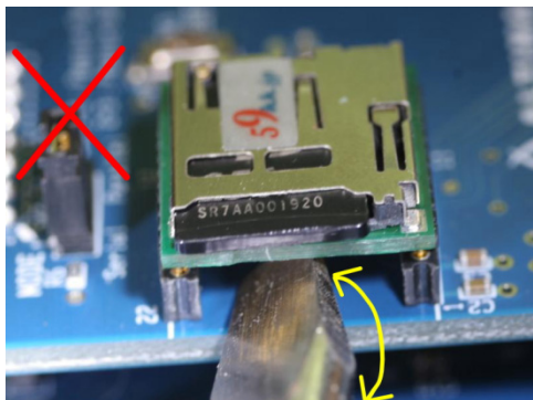
図 11.2 取り外しの悪い例
